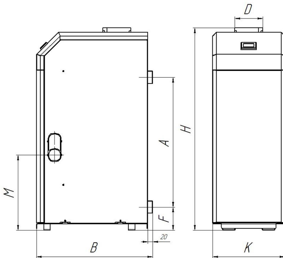
Рисунок 2 Габаритные размеры котла
